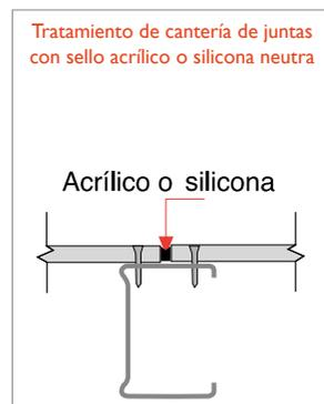
Para tratamiento de juntas verticales en estructura de madera o metal, se recomienda mantener una separación mínima entre placas de 2 mm.
